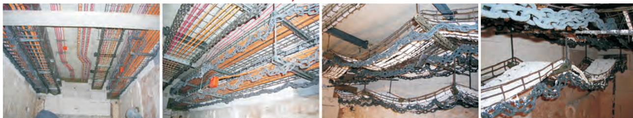
Вид перед и после проведения испытаний на огнестойкость кабельной трассы, выполненной из проволочных лотков
