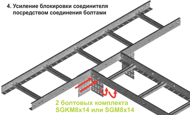
Пример монтажа приставного соединителя LDDKP1 с кабельростами, соединенными угловым соединителем LKUC1
