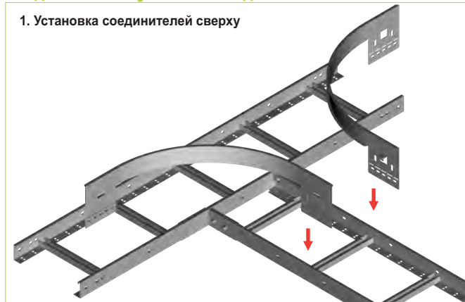
Приставной соединитель LDDKP3 (LDDKC3) подходит для кабельростов Н45.
