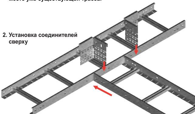
Угловой соединитель универсальный LKUC1 подходит для кабельростов Н50, Н80 и Н120.
