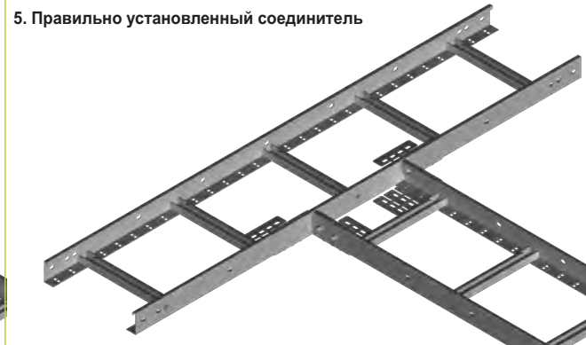
Угловой соединитель универсальный LKUC1 подходит для кабельростов Н50, Н80 и Н120.
