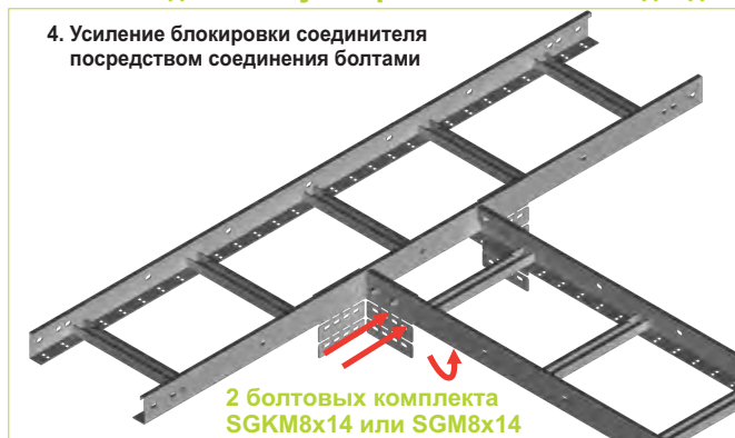
Пример монтажа приставного соединителя LDDKP2 с кабельростами, соединенными угловым соединителем LKUC2
