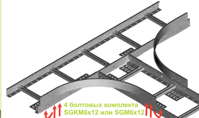
Приставной соединитель LDDKP1 (LDDKC1) подходит для кабельростов Н50, Н80 и Н120.
