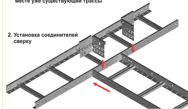
Угловой соединитель универсальный LKUC2 подходит для кабельростов Н60 и Н100.
