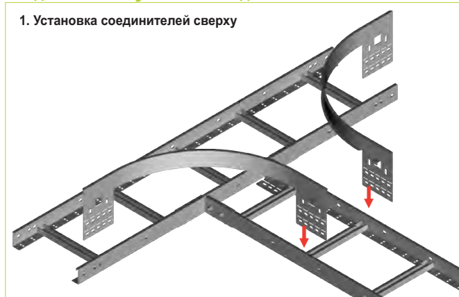
Приставной соединитель LDDKP2 (LDDKC2) подходит для кабельростов Н60 и Н100.
